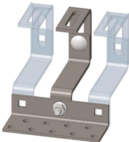
In caso di fissaggio su una copertura in legno, le parti centrali della staffa con le regolazioni in altezza, possono essere fissate al piede in 3 differenti posizioni, semplificando l'allineamento tra i travetti della copertura e la posizione delle tegole.
